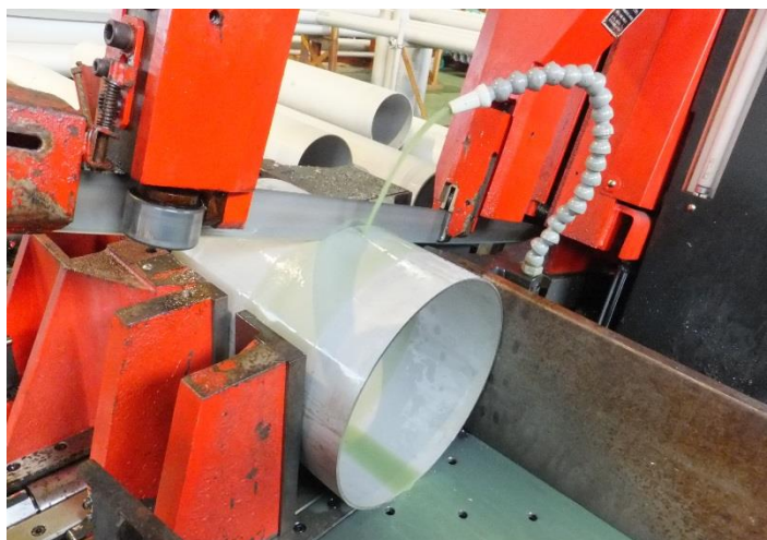
パイプ切断（各種パイプの加工にも対応可能です。）
